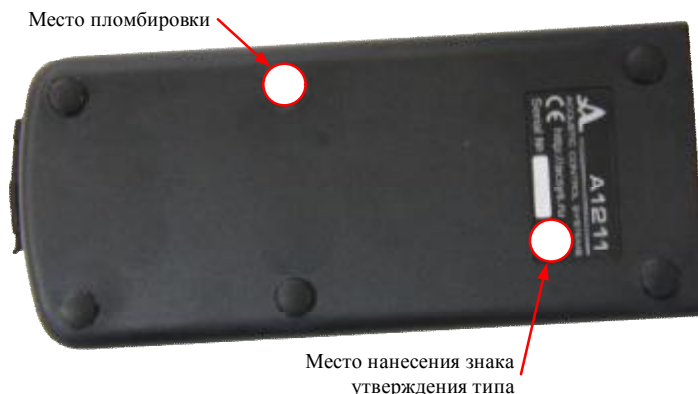
Рисунок 2 – Место пломбировки корпуса дефектоскопа и место нанесения знака утверждения типа
